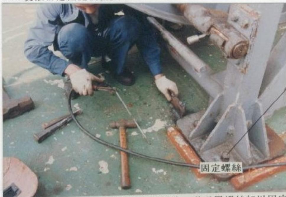
上圖顯示水中受波器絞架吊卸於後甲板後，用螺絲加以固定的情形，以防架子滑動，若天象不佳時需再加鋼纜固定，以維安全。
