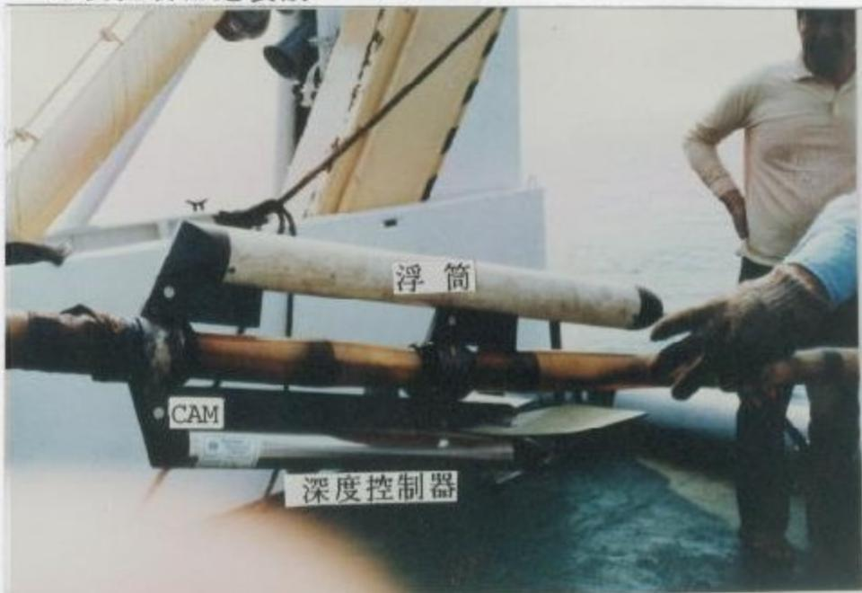
本系統為24頻道之水中受波器，分為6節，目的為控制水中受波器於一定深度，深度控制器裝置於節與節間連接之處，計置放6組。深度控制器主機及浮筒的固定方式為將其裝至collar之槽內後，用1/2"之Nutdriver 板手將浮筒及深度控制器之凸形螺絲 (cam)轉鬆即可。在放入水中之前，須用3/16" 之板手插入tailpiece 內，往前推將深度控制器housing 內之空氣排出，最後用塗有Loctite溶液之3/32"之螺絲鎖入 nosepiece中。（見5-3.2 節圖）
