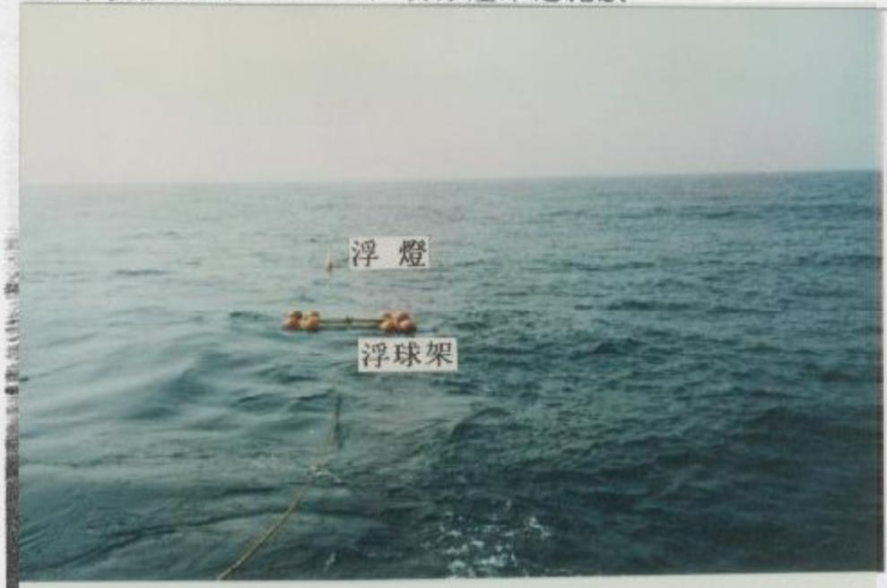
上圖為浮燈架施放實景，連接於水中受波器尾端浮球架上之浮燈為感光式閃光器，主要為晚間拖曳時識別及警告用，施放前先檢視閃光浮燈是否正常？（可用不透光之物品蒙住查看）
