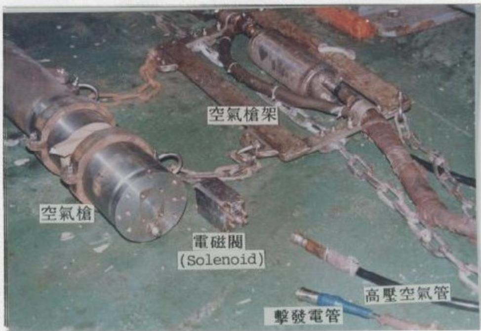
上圖為空氣槍槍架、擊發電管、高壓空氣管、電磁閥 (solenoid) 和高壓空氣槍的實景，裝配之前先啓動高壓空氣將管路內之雜質清除，使不致影響空氣槍運作。
