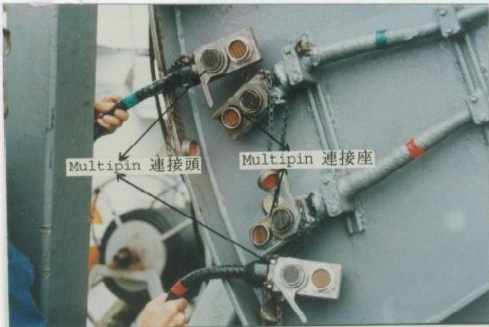
在水中受波器施放至定位後，立即將水中受波器滾輪絞架固定，然後將Multipin接頭（連接至DFS-V）和水中受波器滾輪絞架邊之Multipin連接座（為水中受波器起頭），依上圖所示紅綠記號連接。
