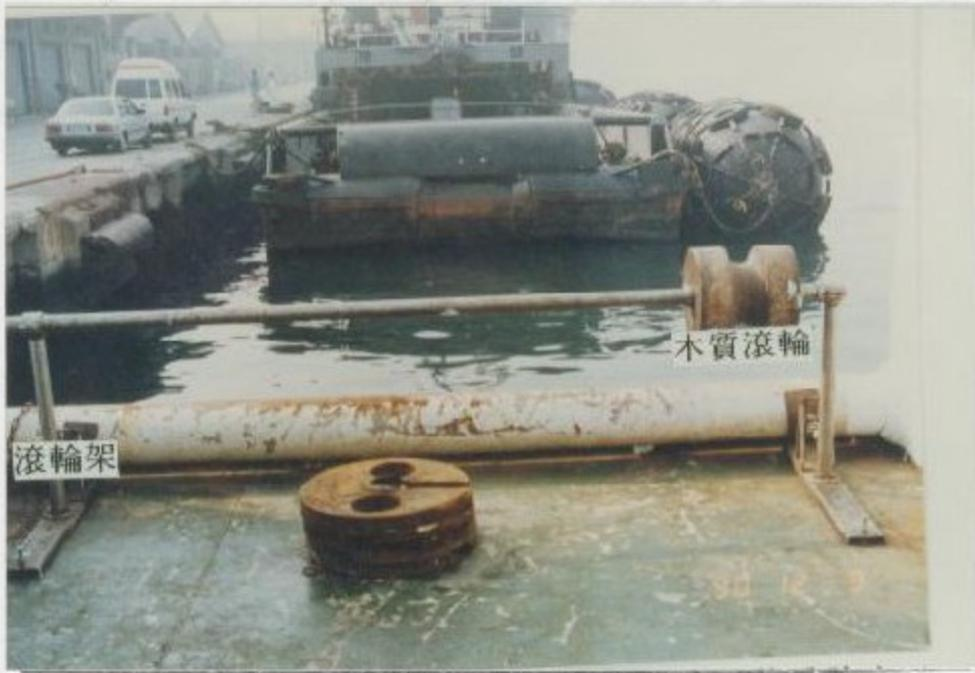
圖中為將水中受波器釋放用滾輪架之固定情形，目的為防止水中受波器釋放時由於摩擦破損，影響作業之進行。
