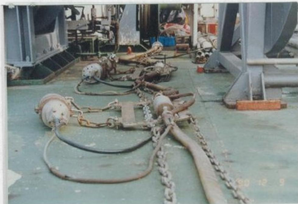
上圖為 AIR GUN ARRAY裝設完成實景，在完成後必須於每個U形環用鋼絲固定並確定槍上每個螺絲已加上pin 予以固定，然後以10 Bar壓力試爆空氣槍，觀察槍是否正常？
